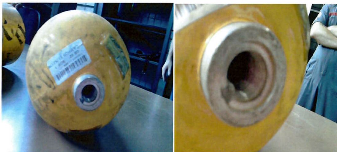
FIGURA 15 – Cilindro com roscas danificadas (Fotografia - tirada na oficina do Corpo de Bombeiros)
