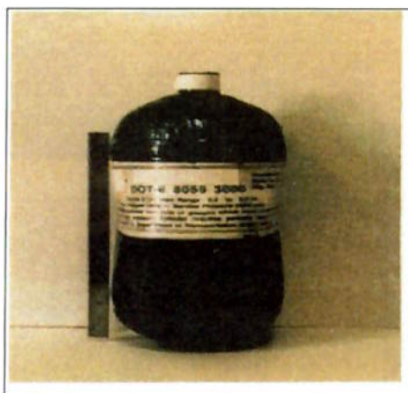
Figura 10 - Dano por impacto nível 3 (condenado)
