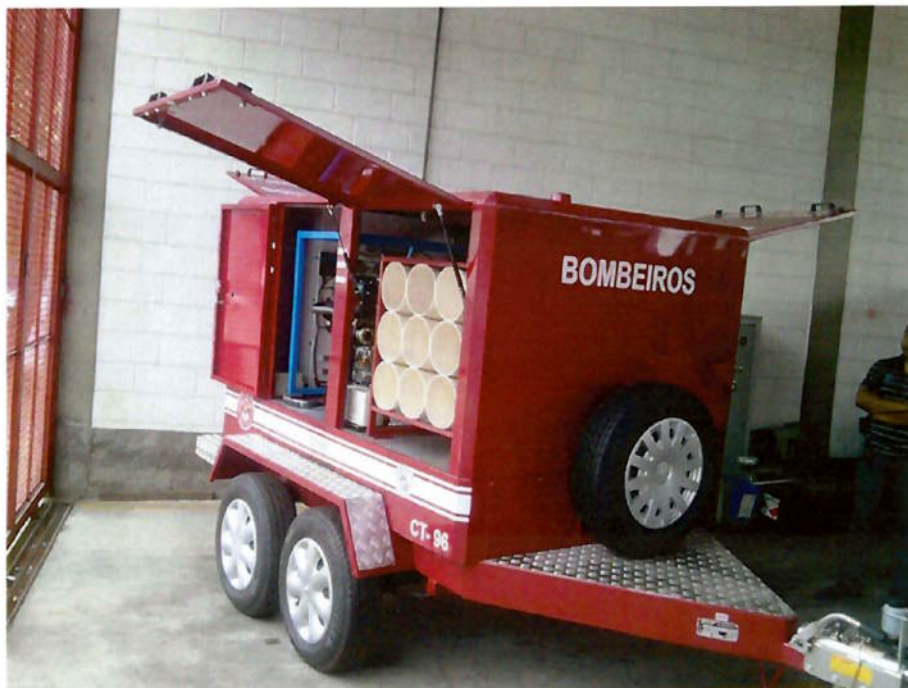
FIGURA 24 - Estação de recarga móvel.
