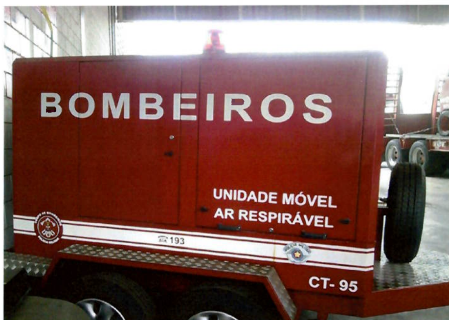
FIGURA 25 - Vista lateral da estação de recarga móvel.
