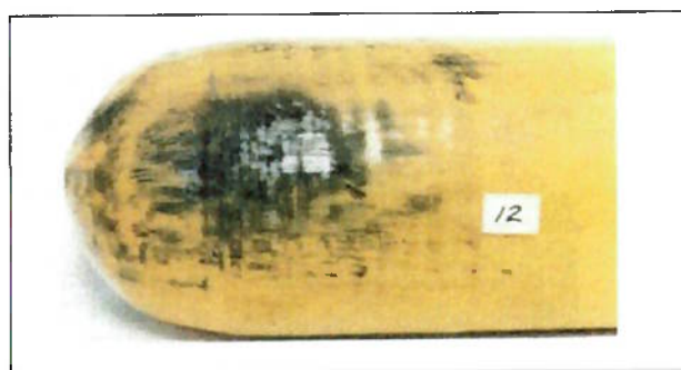
Figura 12 – Dano por fogo nível 3
