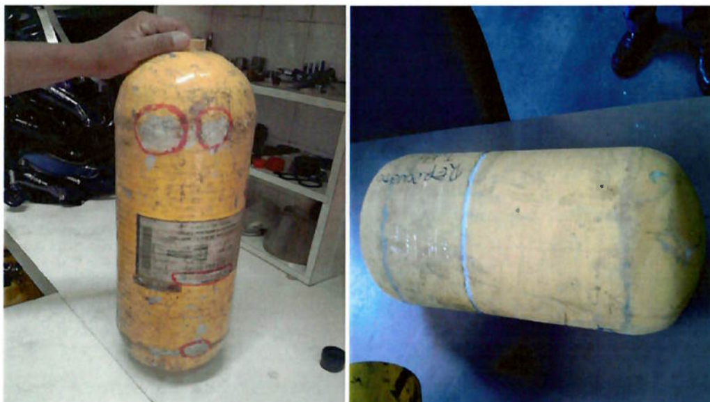
FIGURA 14 – Cilindros Condenados (Fotografia - tirada na oficina do Corpo de Bombeiros)
